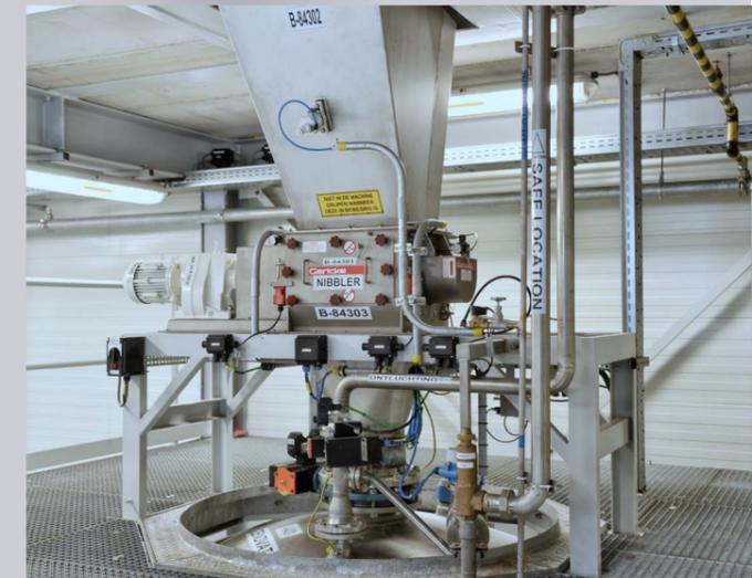
Calibrage de la matière première en amont de l'alimentation d'un réacteur
