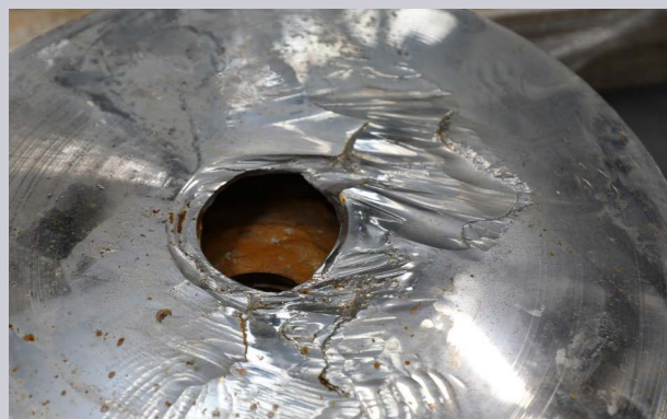
Abrasão causada por pigmentos em uma válvula rotativa. As nossas robustas válvulas rotativas para serviços pesados simplificam as manutenções nessas fábricas.
